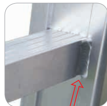
Pioli passanti ribordati e fissati con saldatura supplementare
