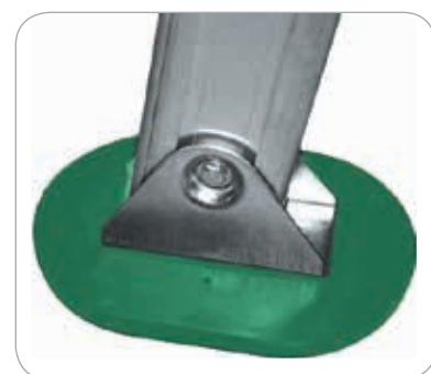
Piede snodo gommato con anima d'acciaio, di ampie dimensioni (16x11 cm), anti affondamento
